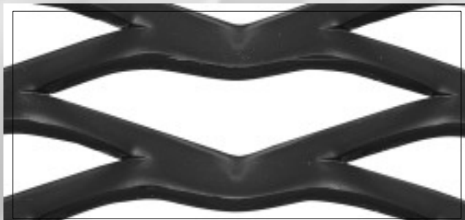
FILS1 • 110 x 40 (25,4) x 7 x 4 mm - 17 kg/m 2
